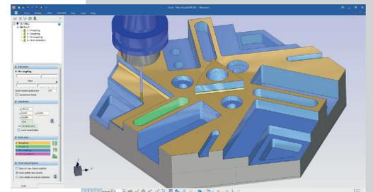
Simulación de mecanizado
