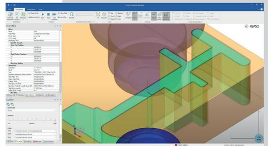
Simulación de mecanizado
