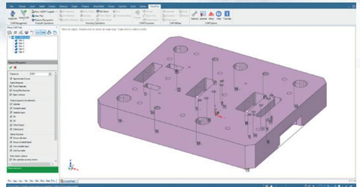
*"Automatic Feature Recognition" permite seleccionar todos los elementos a cortar automáticamente..*
